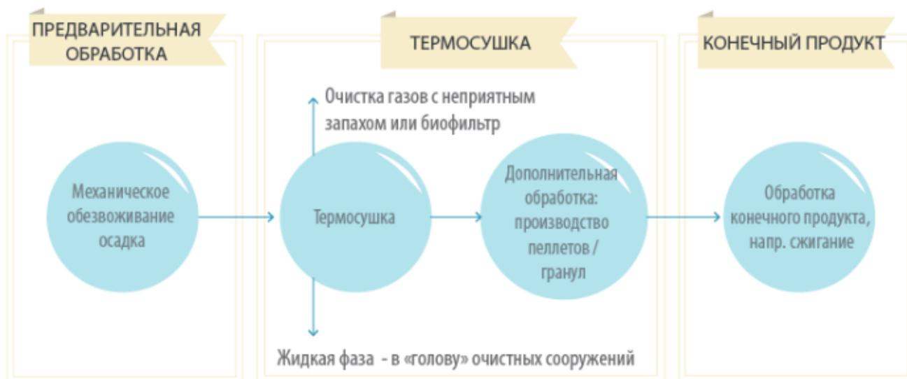
Рисунок 3.10 - Принципиальная схема термической сушки
