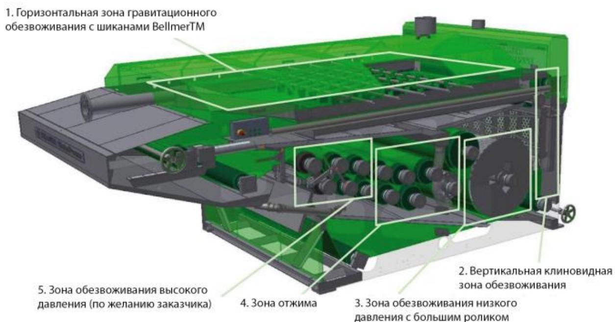
Рисунок 3.8 - Принципиальная схема ленточного фильтр-пресса
