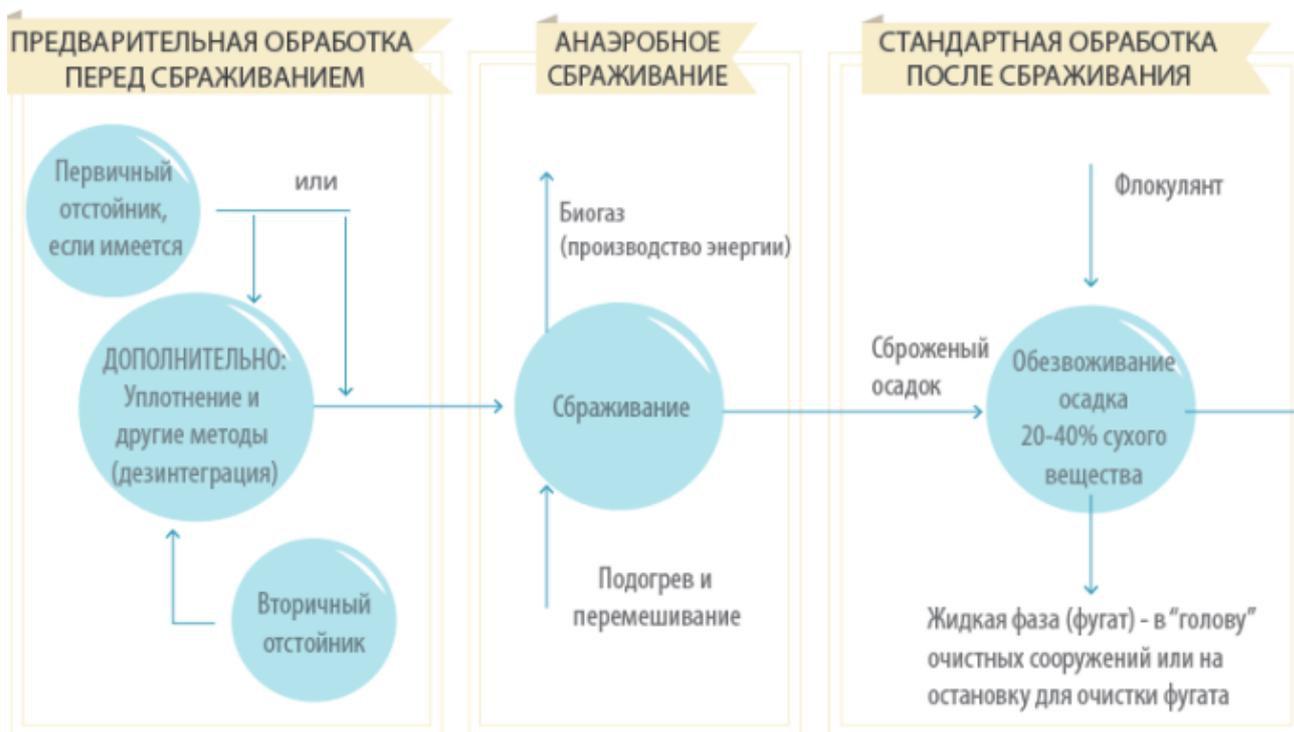
Рисунок 3.6 - Анаэробное сбраживание в цепи обработки осадка
